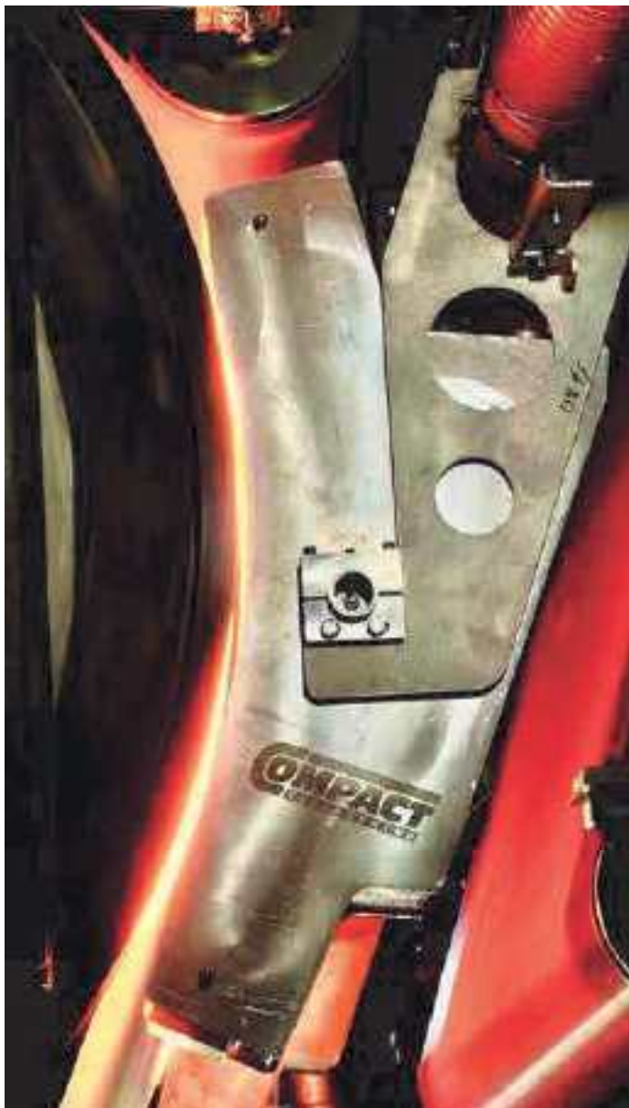
Abb. 1: Infrarottiefentrocknung mit eNIR Corona als Randtrockner
