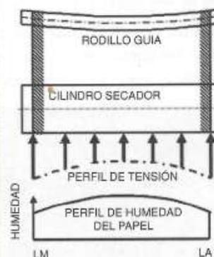
FIG. 3. INFLUENCIA DE RODILLOS-GUÍA DOBLADOS SOBRE EL PERFIL DE HUMEDAD.
